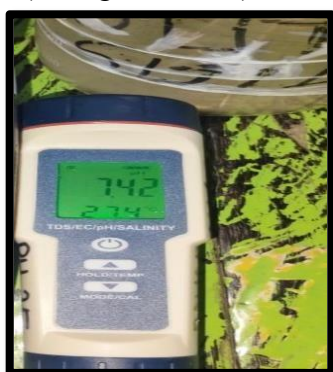
Gambar 2. Pengukuran pH dengan pH meter pada lokasi penelitian
