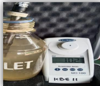
Gambar 3. Pengukuran TSS di lokasi penelitian
